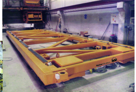
Tyst vibrering av element av betong med vibrationsbord samt serie GyroShake®
